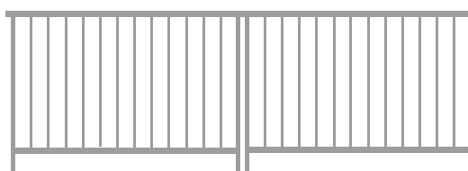
BP 041 Barandilla modular con perfiles metalicos pasamanos 60 x 30 barrotes en pletina 50 x 8 inferior 60 x 30
