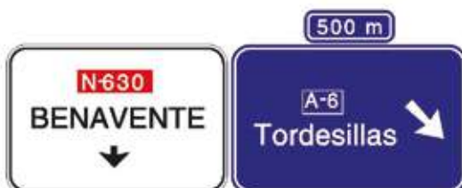
S-232a Preseñalización con señales sobre la calzada en carretera convencional hacia autopista o autovía y dirección propia
